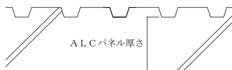
解説図－3 外壁用意匠パネルの最大支点間距離算定用の ALC パネル厚さ（断面図）
