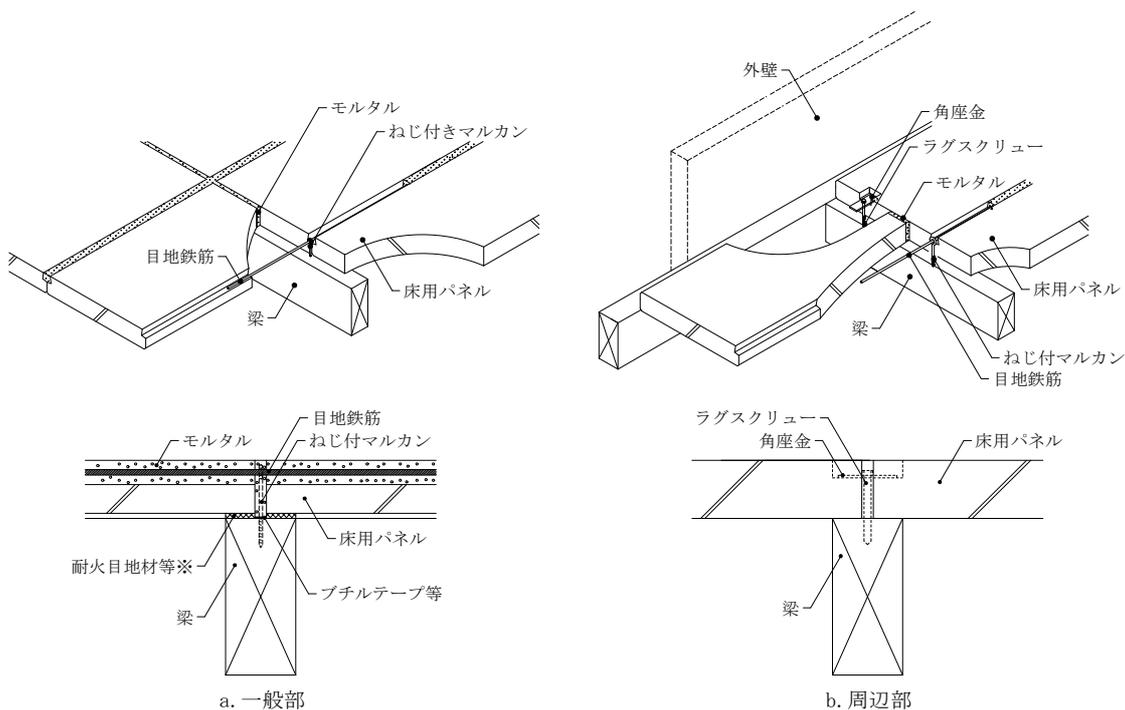
※ 必要に応じて、梁に接するパネルの面取り部に耐火目地材等を充填する。「5.4.5 b.」を参照。
