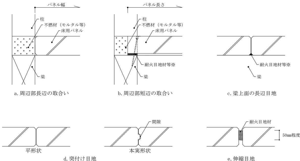
※ 必要に応じて、梁に接するパネルの面取り部に耐火目地材等を充填する。「5.4.5 b.」を参照。
