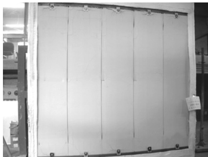
写真1 縦張構法の試験終了時（加熱側）
