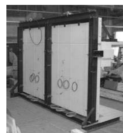
写真1 試験体(非加熱側)
