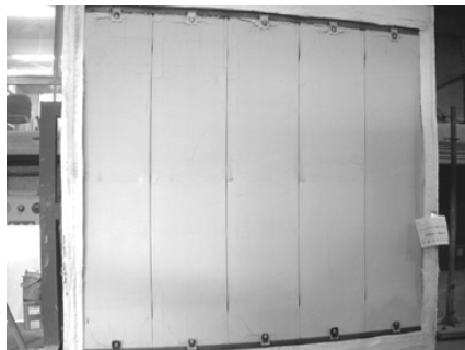
写真1 縦張構法の試験終了時（加熱側）
